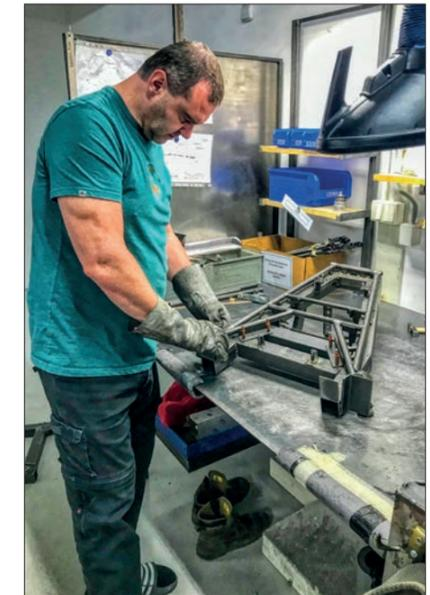
**Toutes les plaques d'aluminium sont découpées et percées grâce à des machines numériques. À droite, dans un des ateliers de soudage, on réalise les bâtis moteur. Toutes les pièces des XL8, B23 et FB8 sont fabriquées ici sauf l'avionique, le moteur et les sièges.**
